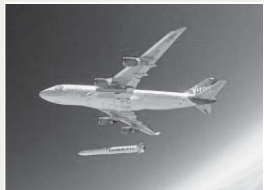
航空機から人工衛星を打ち上げ
